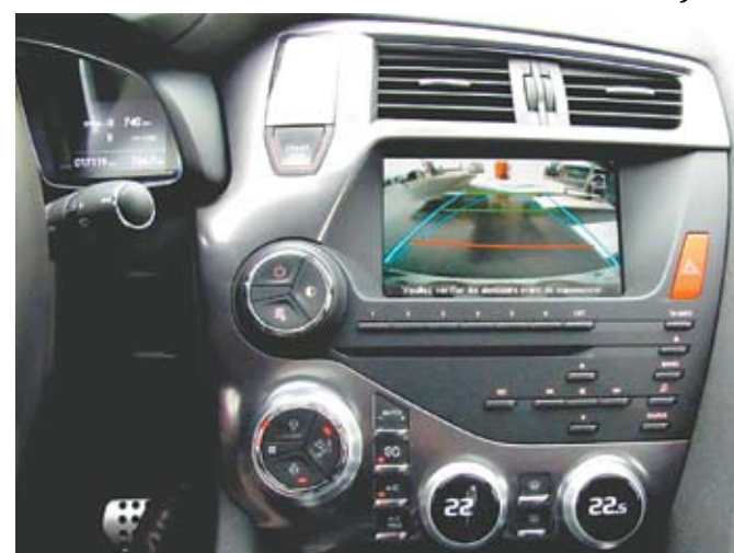
No painel de controle, a câmera instalada no para-choque traseiro informa com cores a proximidade de objetos, e espaço para o estacionamento ideal. Os botões do ar condicionado digital individual são eficientes e de fácil acesso
